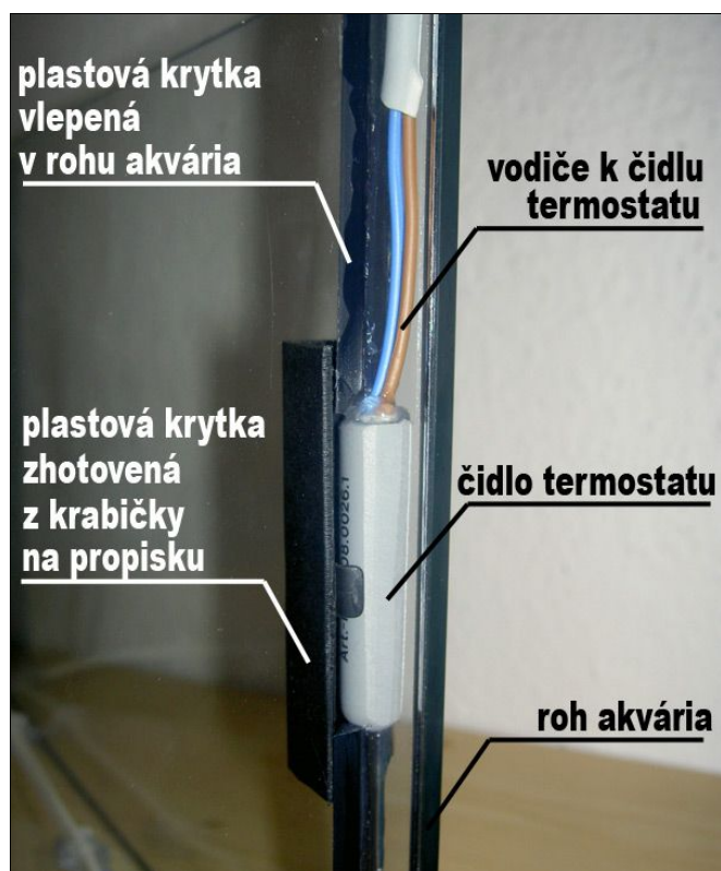
Uložení a zakrytí čidla termostatu v druhém rohu akvária. (Foto: Michal Toufar)
