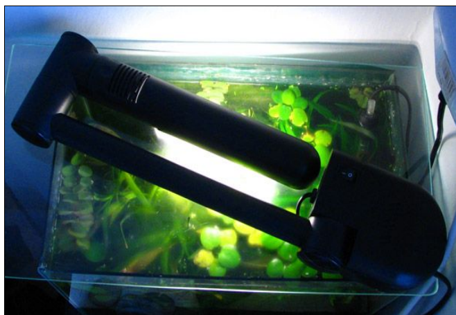
Stolní lampa s 9 W PL-S zářivkou. Výhodou je kromě ceny i možnost vybrat zdroje s různou teplotou chromatičnosti (3000, 4000 a 6500 K) – nevýhoda je na snímku zřetelná: trubice má délku jen 15 cm a neosvětlí tak rovnoměrně celé akvárium; celá lampa ale měří skoro 40 cm.
