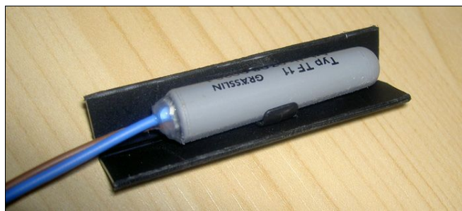
Čidlo termostatu s vyrobenou krytkou. (Foto: Michal Toufar)
